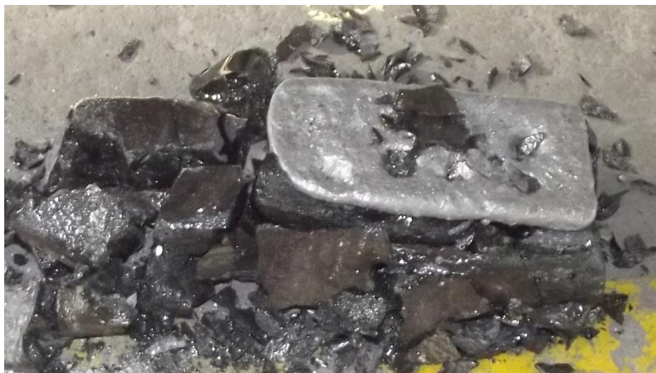
Figura 4. Placa de FeNi encontrada em meio a escória após a desmoldagem da lingoteira.
