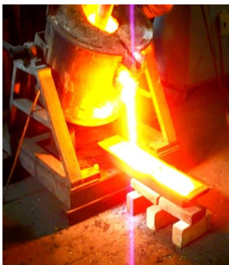
Figura 3. Vazamento de carga líquida na lingoteira.
