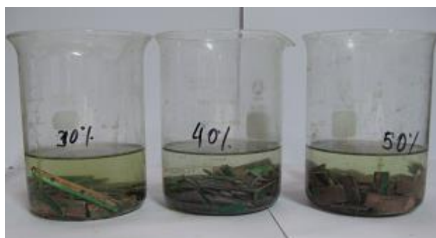
Figura 5. Soluções após a cementação do cobre.
