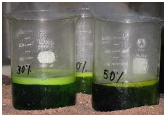
Figura 3. Ataque dos resíduos com HCl e adição de HNO 3 .
