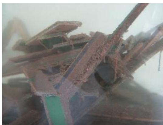
Figura 7. Aspecto do cobre cementado.
