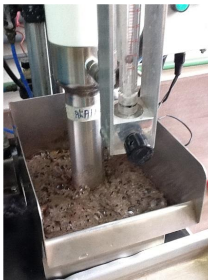
Figura 2. Célula de flotação com o minério em estudo.
