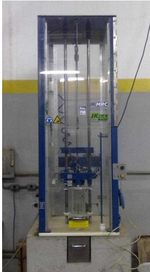
Figura 2. JKTech DWT instalado no CETEM.
