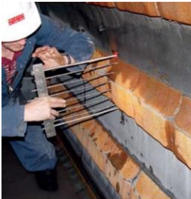
Figura 1. Modelo de aferição do perfil do moinho de bolas. FONTE: Weir Minerals.
