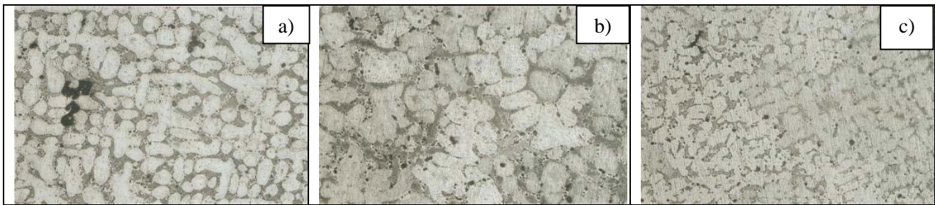
Figura 1. Macrografias de diferentes regiões do anodo A: a) Região do anodo em contato com o ar; b) região central do anodo; c) região do anodo em contato com o molde (50X).
