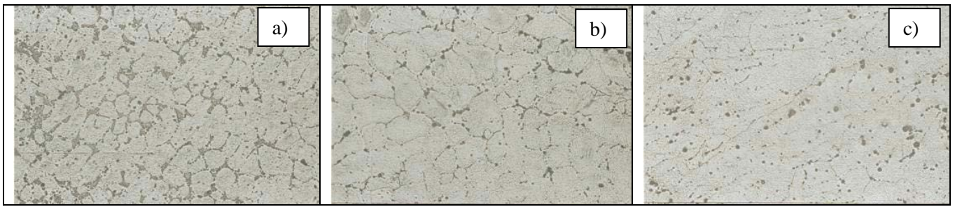
Figura 3. Macrografias de diferentes regiões do anodo B. Observa-se diferente tamanho de grão e com diferente quantidade de precipitados em a), b) e c) (50X).
