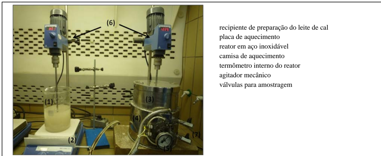
Figura 3. Aparato experimental para preparação do TCA
