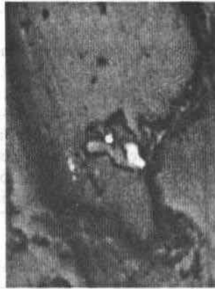
Figura 1. Grano de cuarzo con inclusión de calcopirita y oro.
