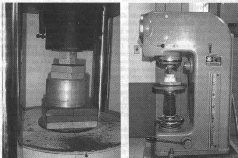
Figura 1 – Prensa (à esquerda) e durômetro utilizado nos ensaios.
