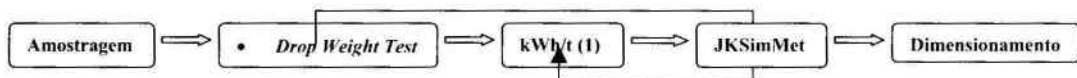
Figura 1 – Método para determinação da energia específica unitária e posterior dimensionamento de moinhos através da linha australiana.
