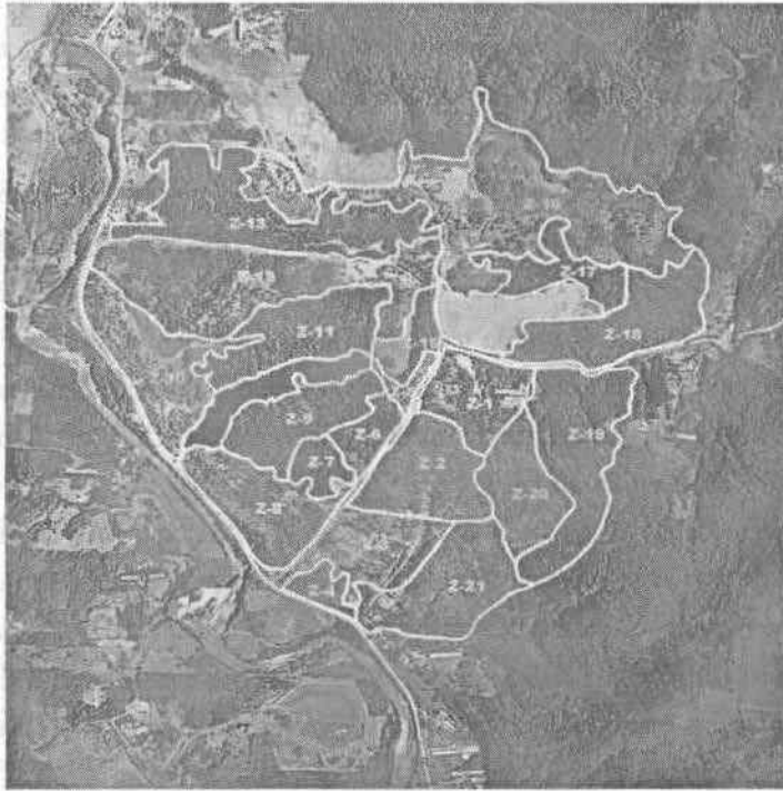
Figura 1 – Zoneamento geológico-geotécnico em área degradada pela mineração de carvão, realizado a partir de fotografia aérea em formato digital.
