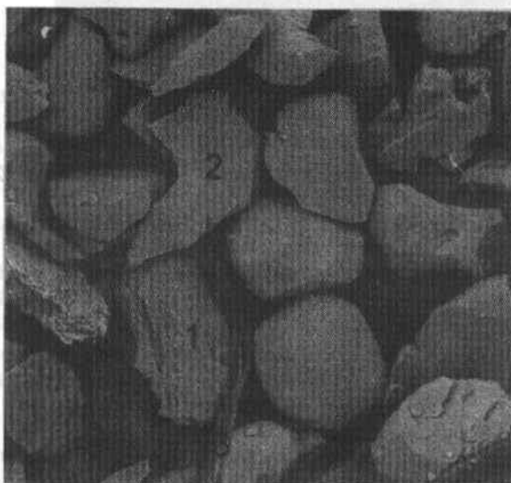
Foto 1. Fotomicrografia da fração +0,062 mm do caulim com aumento de 200x. Observa-se a presença de grãos de K-feldspato em processo de caulinitização (1), grãos de quartzo (2) e mica (3).
