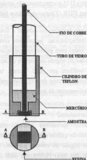
Figura 1 - Representação esquemática do eletrodo de trabalho utilizado nos experimentos de laboratório.
